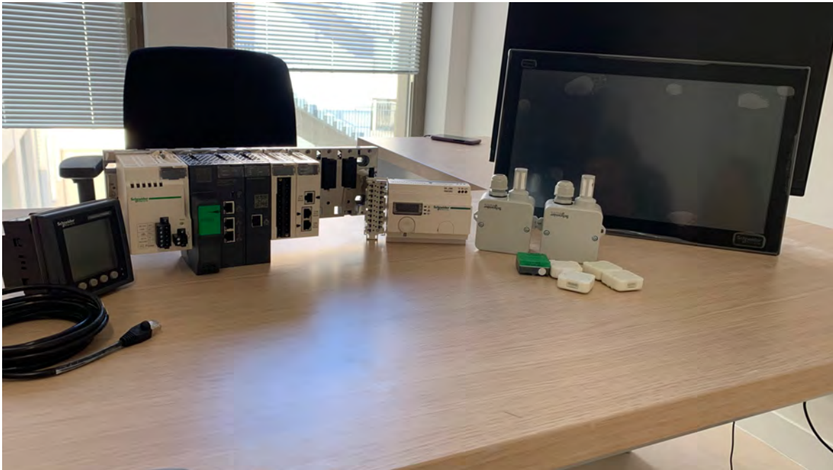
FIGURE 10 – Aperçu des composants matériels de la plateforme CERES hors de leur boîtier : de g. à d., la connectique, les automates, les sondes, et l’interface homme-machine.
